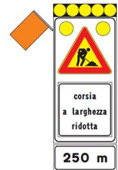
Figura 14: "segnale mobile di preavviso" derivato dalla fig. Il 400 Art.39 Reg. da impiegare per lavori sulla sola corsia di emergenza. E' integrato con set di 6 lampade a led ad alta efficienza luminosa diam. 300 mm (con possibilità di lampeggio sincrono e sequenziale) e con sbandiatore elettromeccanico posto in alto sul lato esposto al traffico.
